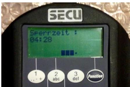
Nach kurzer Zeit wird die Helligkeit des Displays reduziert.
