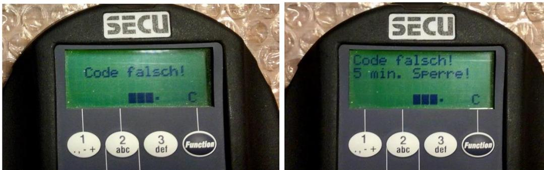
Das Display schaltet nach dieser Anzeige um und es wird die Restlaufzeit der Sperre angezeigt.
