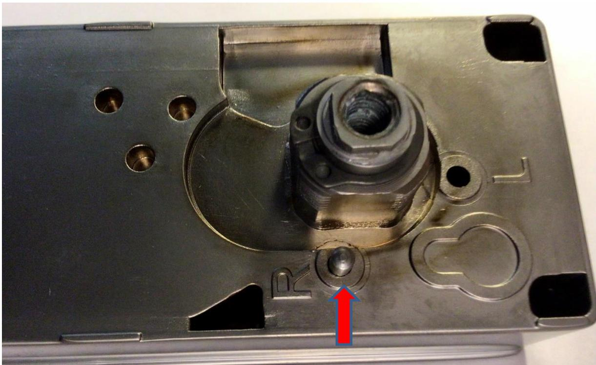
Ist der Türanschlag vor dem Schlosswechsel nicht eindeutig zu ermitteln, wird der Stift beigelegt. Entsprechend der Stiftposition des defekten Schlosses ist der Stift in das neue Schloss bis zum Anschlag einzudrücken.
